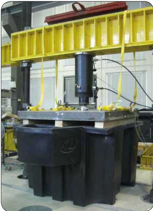
Auffangwanne PE-KT-EP6 unter einer Prüflast von 6000 kg
