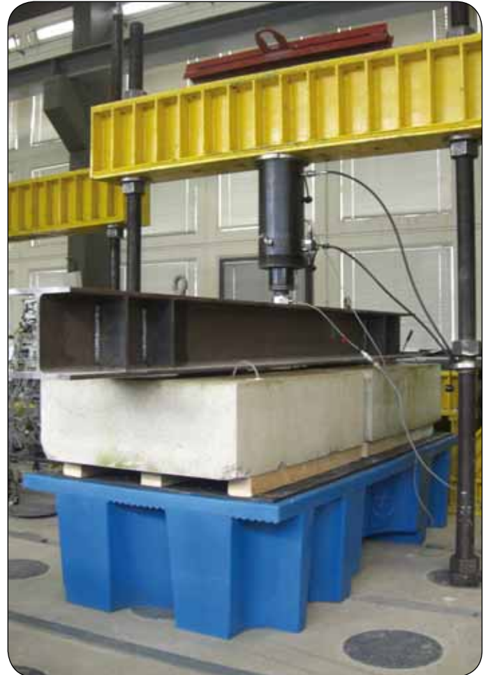
Auffangwanne PE-KT-EP5 unter einer Prüflast von 12000 kg
