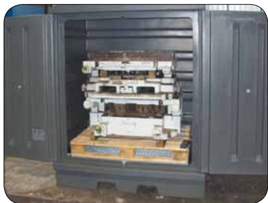
PE-200-EP8 unter einer Prüflast von 2400 kg
