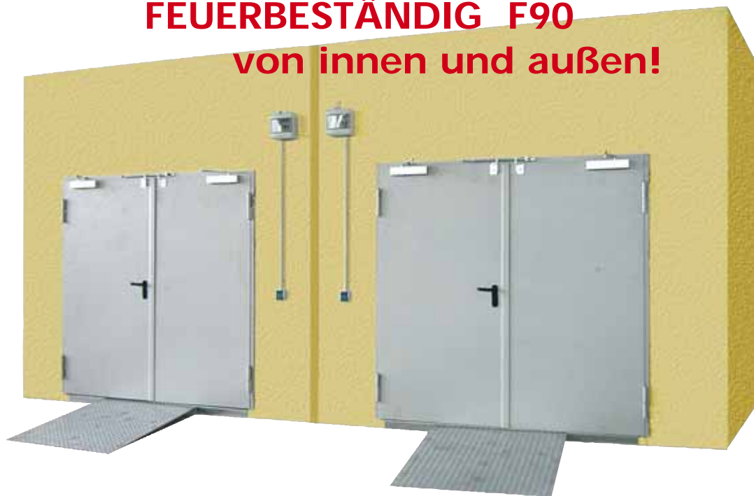
2 Stück Brandschutzdepots BSD mit 2-flügeligen selbstschließenden Toren, zwei separate Brandabschnitte realisiert, geringe Höhe der Auffangwanne zum besseren Beschicken mit Gabelhubwagen
