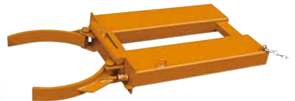
FG 2216/1, RAL 2004 - reinorange, Artikel-Nr. B69-6356-A, L x B x H in mm: 1285 x 710 x 150, Tragkraft: 400 kg
