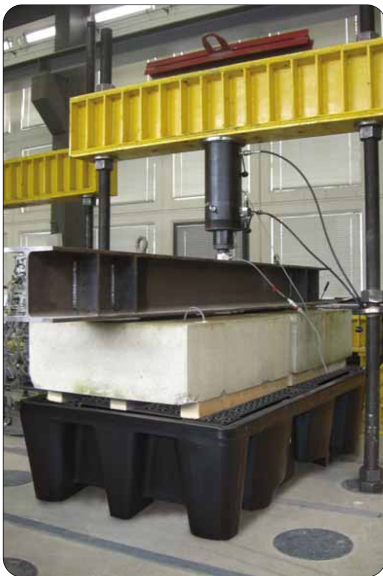
Auffangwanne PE-KT-2 unter einer Prüflast von 16.000 kg
