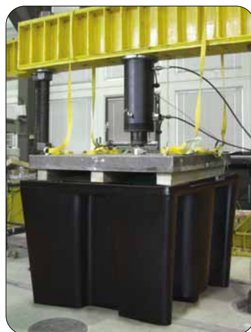
Auffangwanne PE-KT-1 unter einer Prüflast von 8.000 kg
