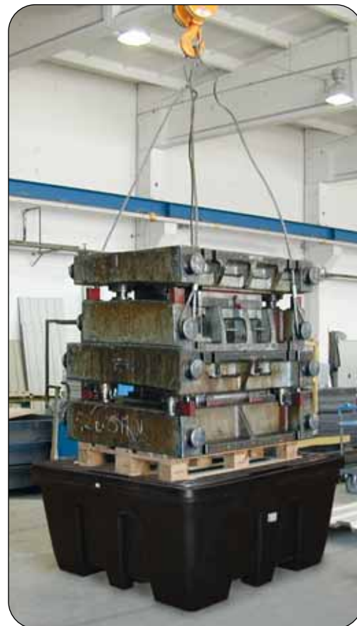
Auffangwanne PE-KT-1S unter einer Prüflast von 8.000 kg
