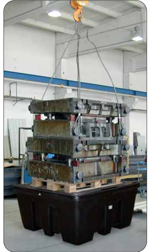
Auffangwanne PE-KT-15 unter einer Prüflast von 8.000 kg
