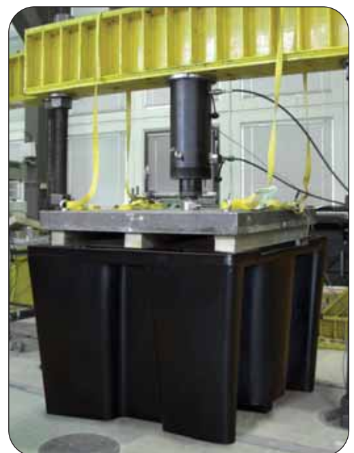
Auffangwanne PE-KT-1 unter einer Prüflast von 8.000 kg
