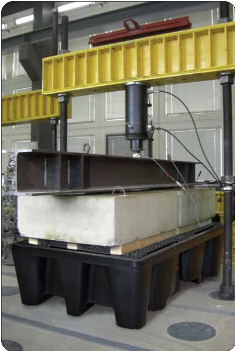
Auffangwanne PE-KT-2 unter einer Prüflast von 16.000 kg
