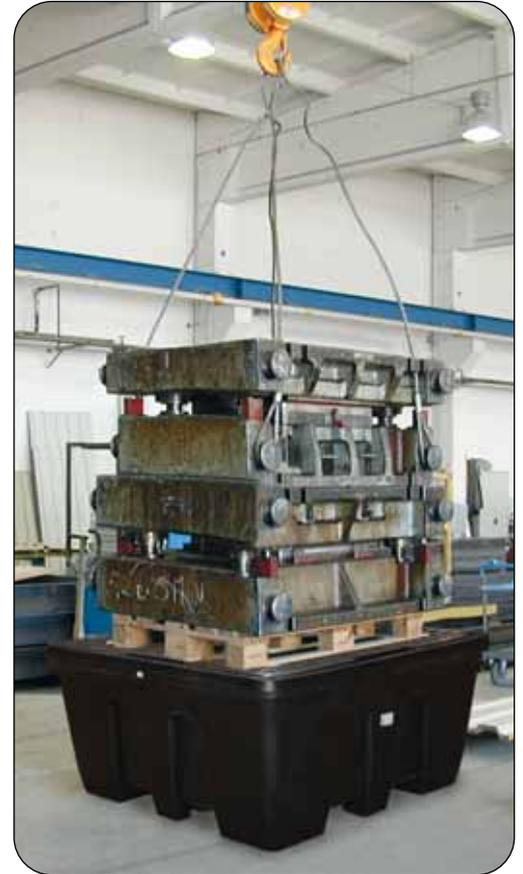
**Auffangwanne PE-KT-1S unter einer Prüflast von 8.000 kg**
