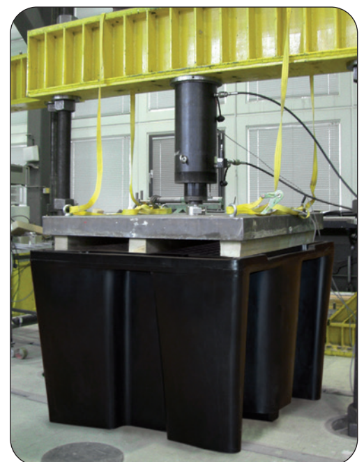
Auffangwanne PE-KT-1 unter einer Prüflast von 8.000 kg
