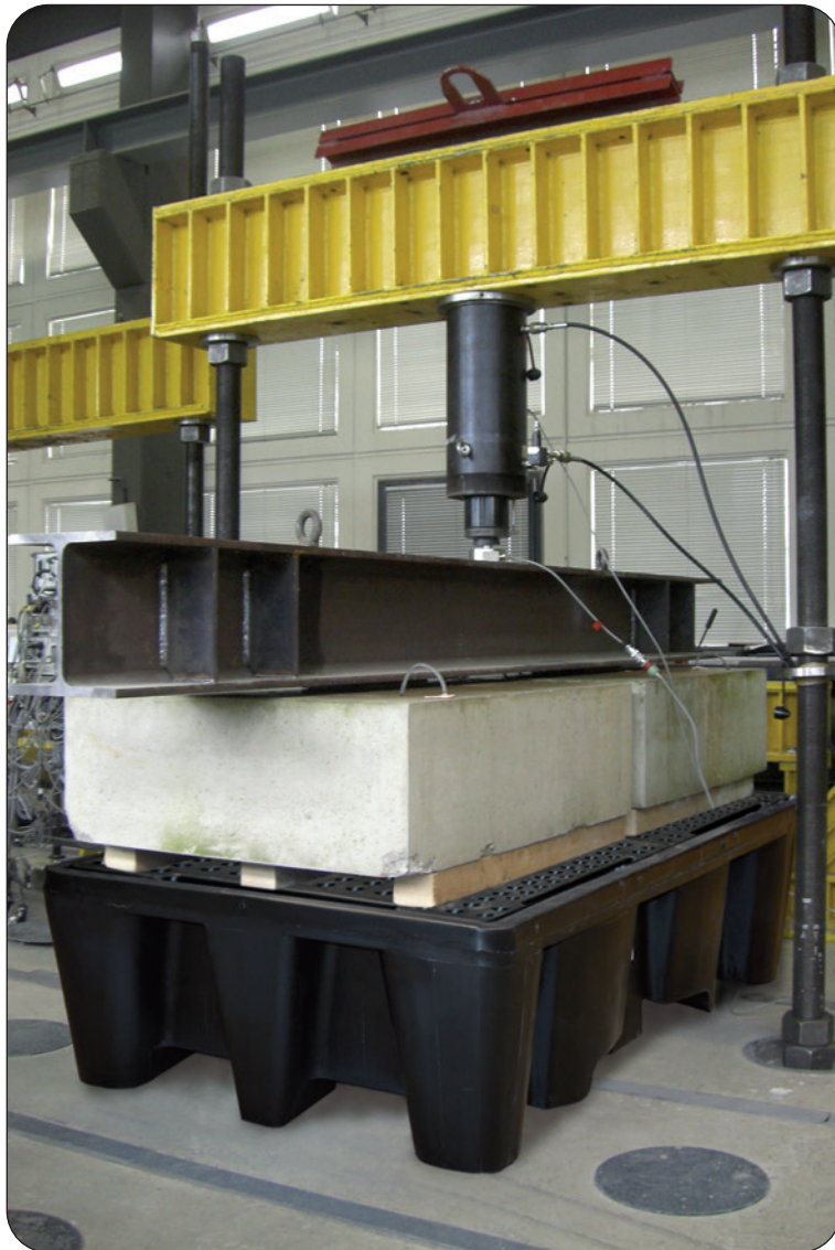
Auffangwanne PE-KT-2 unter einer Prüflast von 16.000 kg
