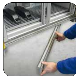
Schrank unterfahrbar mit Hubwagen durch abnehmbare Sockelblende
