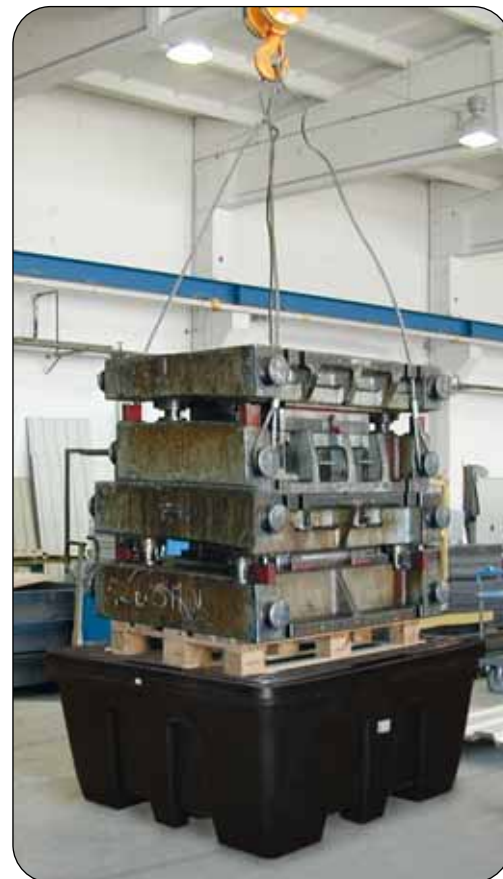
Auffangwanne PE-KT-1S unter einer Prüflast von 8.000 kg
