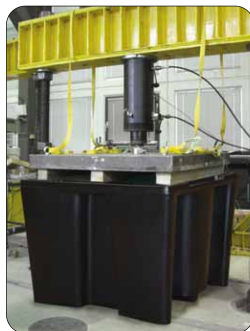
Auffangwanne PE-KT-1 unter einer Prüflast von 8.000 kg
