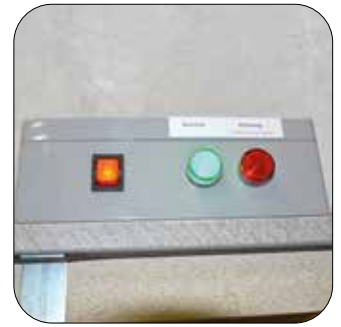
Steuereinheit mit Rauchdetektion
